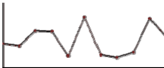
Abbildung 18: Kurve einer einfachen linearen Interpolation zwischen Zufallszahlen
