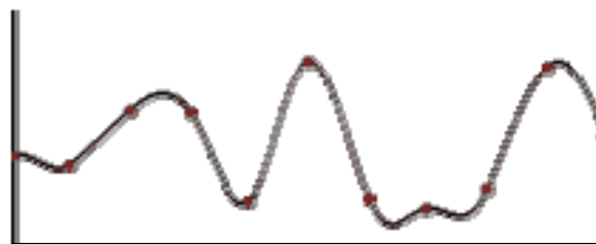
Abbildung 20: Kurve einer kubischen Interpolation zwischen Zufallszahlen
