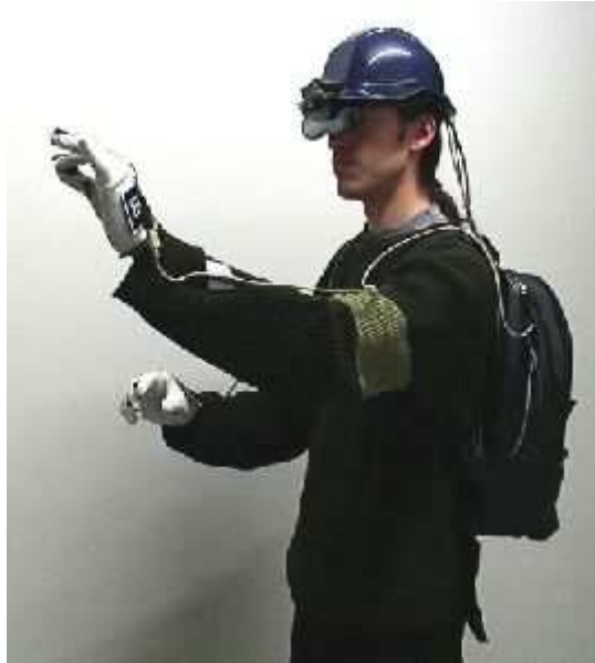
Abbildung 4.9: Zur Interaktion mit der Studierstube können auch Pinchgloves verwendet werden.
