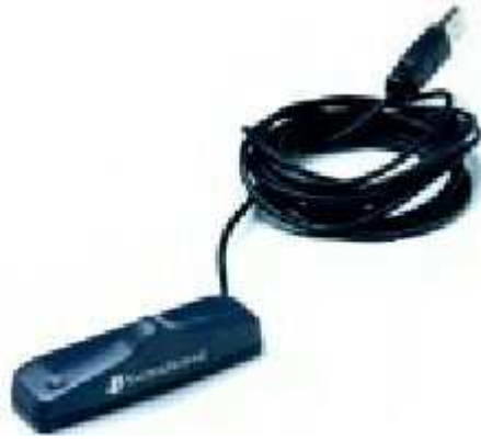
Abbildung 4.6: Für das inertielle Tracking wird das Modell „Intertrax2“ der Firma Intersense verwendet.
