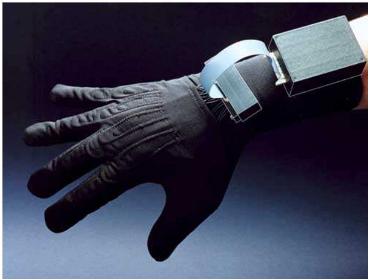
Abbildung 2.10: Ein Datenhandschuh, bei dem die Glasfaserschlaufen in den Handschuh eingearbeitet wurden.
