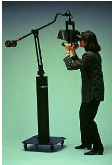
Abbildung 2.17: Beim BOOM wird ein HMD an einem Gelenkarm mit einem Gegengewicht montiert.
