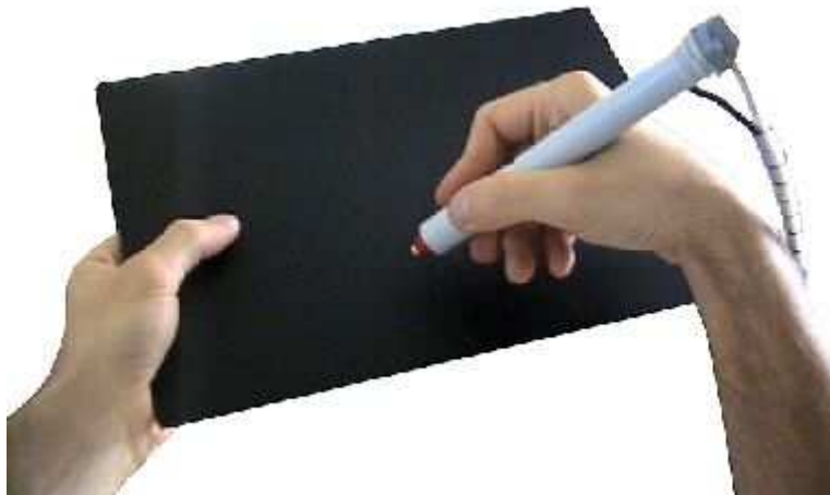
Abbildung 2.12: Bei Pen & Tablet handelt es sich um ein Tablett und einen Stift, die in jeweils einer Hand gehalten werden.
